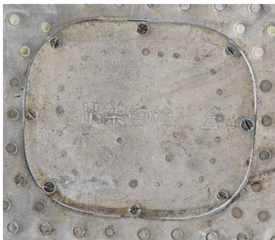
写真5 オリジナルの塗装の痕跡の一例。主翼下面の点検パネルに残る「懸吊架点検孔蓋」というステンシルのもの
