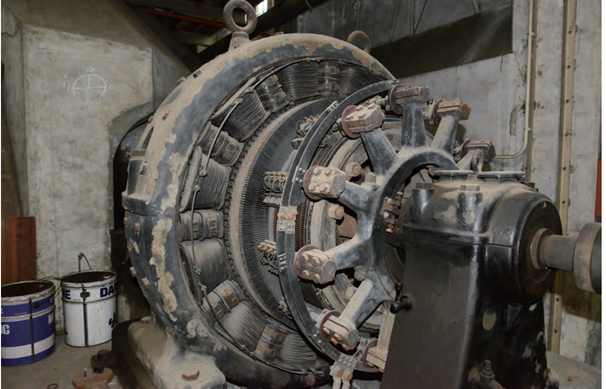
④ 風洞内のプロペラ（直径4 m）を駆動するジーメンスシュッケルト社製の500馬力モーター
