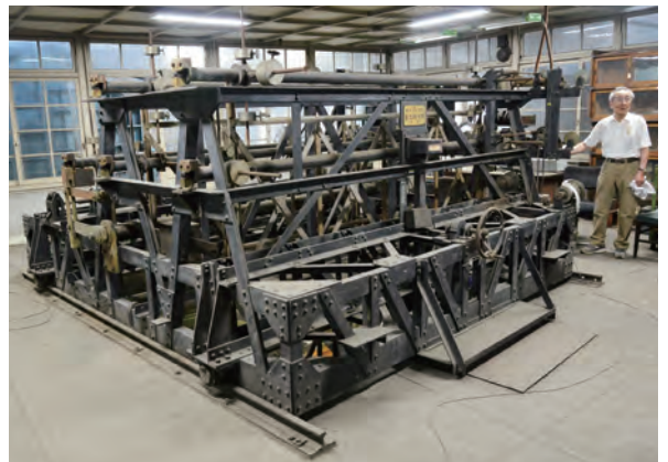
⑤ 吹出口の真上に位置する計測装置（吊線式5分力天秤）
