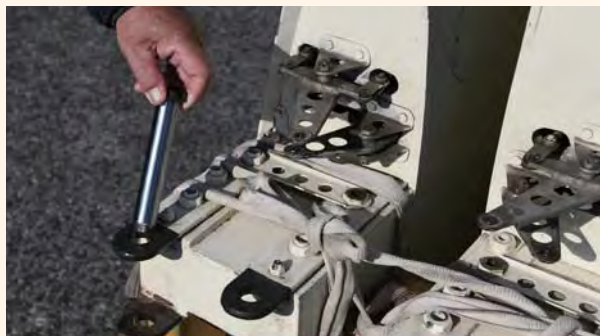
写真7 主翼と胴体を結合するピンと主翼の取付金具
