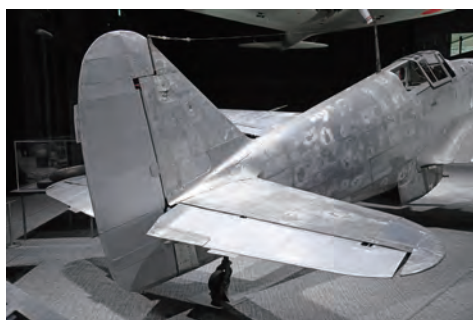
羽布が張り直されたラダーとエレベーター
