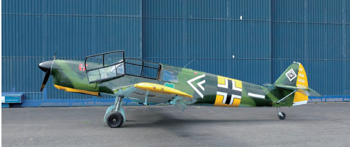
図8 復元協会のノール 1000 (Nord 1000)。復元機と同型のルノー製エンジンを搭載し、昨年テスト飛行に成功した
