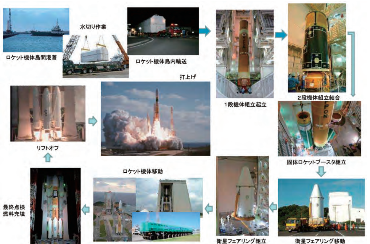
図-5 ロケットの組立・打上げ（H-IIA の例）
