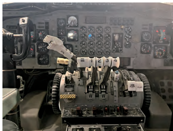
操縦席中央には様々なレバーが並ぶ。左上に突出した FPC レバーは、STOL 実験機ならではの特徴
