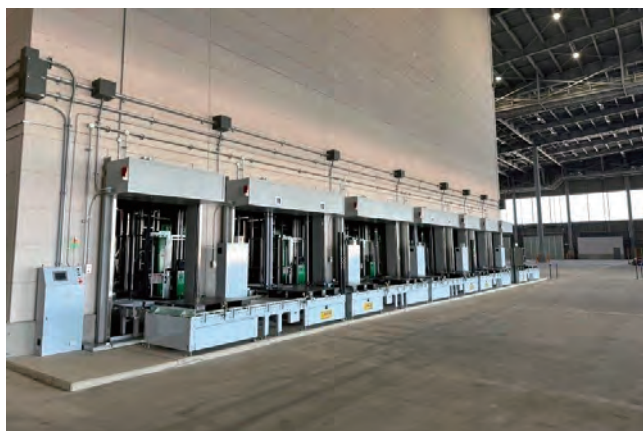
図10 ● 自動高層ラック (BHS : Bulk Handling System)
