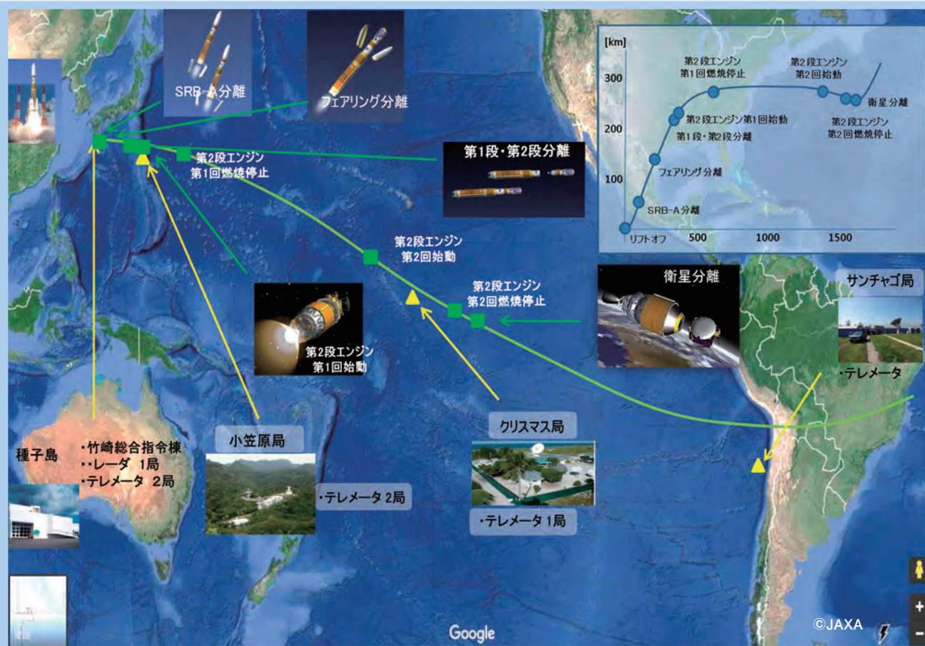
図-6 H-IIA ロケット (GTO ミッション) 飛行経路と地上局配置図
